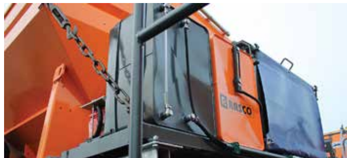
Kjøretøy uten innebygd hydraulikksystem
