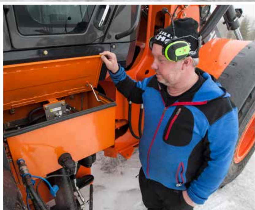
Pär "Lill-Pär" Höglund visar det extra ventilpaketet som monterats lättåtkomligt.
